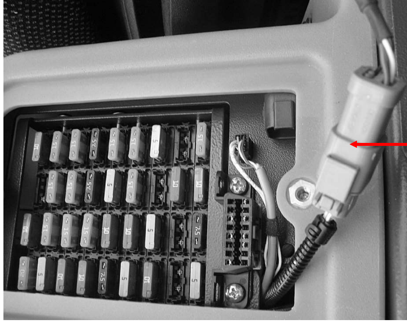
X59 mit angeschlossenem Diagnosekabel zum Yanmar Interface X59 with connected diagnosis cable to Yanmar- Interface
